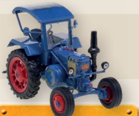
LANZ D 7506A DIN 1952 Tractorul companiei germane Lanz a fost numit „Bulldog” datorită părții frontale caracteristice. Și-a câștigat popularitatea prin eficiența sa ridicată.
