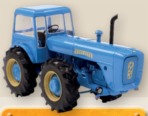
DUTRA D4K DIN 1960 O legendă a mecanizării agricole din Ungaria. Se caracteriza printr-un motor montat pe un cadru anterior punții din față și roți de dimensiuni egale.
